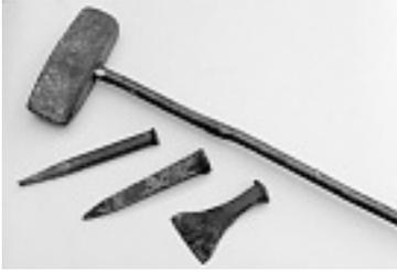
*Die Werkzeuge aus dem Steinbruch : links die „Schlah“, 200 x 65 x 70 mm, 2,5 kg, der Stiel muss elastisch sein, Schwarzdorn eignete sich hierfür, weiterhin sind links „Bockeisen“ zu sehen, die zur Herstellung gerader Kanten benötigt wurden; Unten links und rechts sind Meißel verschiedener Art und Größe abgebildet. (Foto: V. Hintze und K. Gröger)*
